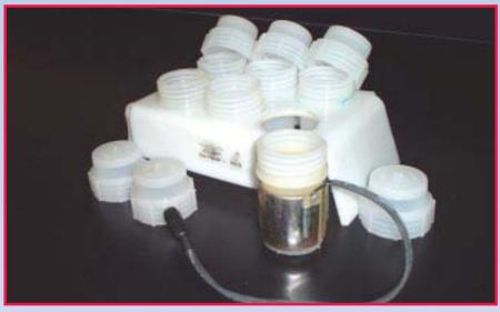
Fig. 4. StainQuick<sup>™</sup> System (Cel-Tek, Inc.).
